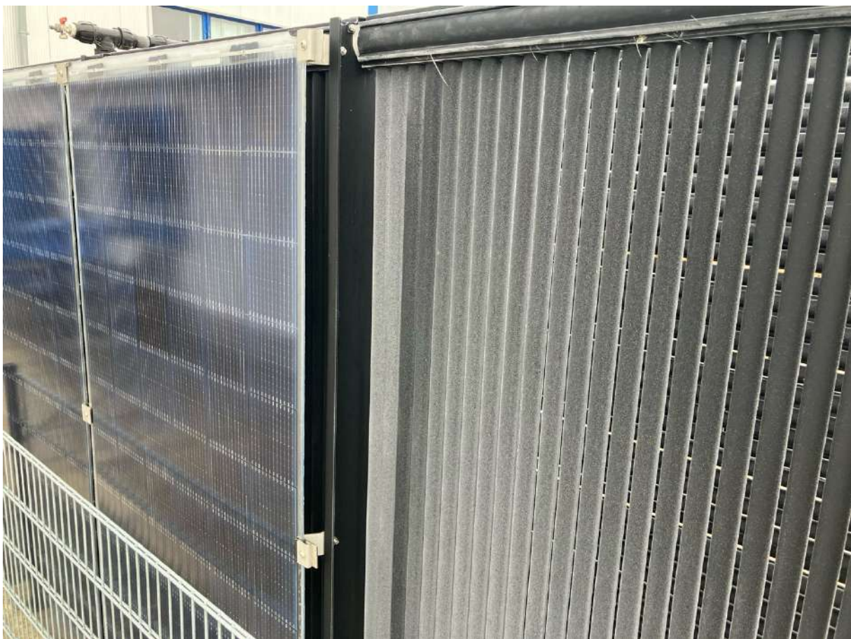
Abbildung 5: AluKol Solarthermischer Sole-Luft-Kollektor, links mit in Abstand montiertem PV-Laminat, rechts ohne PV-Laminat (Foto: TBE)
